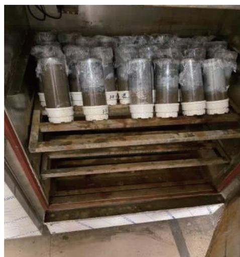
图 2 干湿—冻融实验圆柱装置
