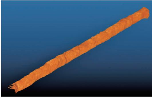
图 5 巷道整体激光点云地图
