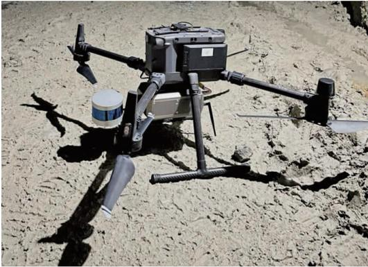
图2 井下无人机载三维激光扫描测量系统
